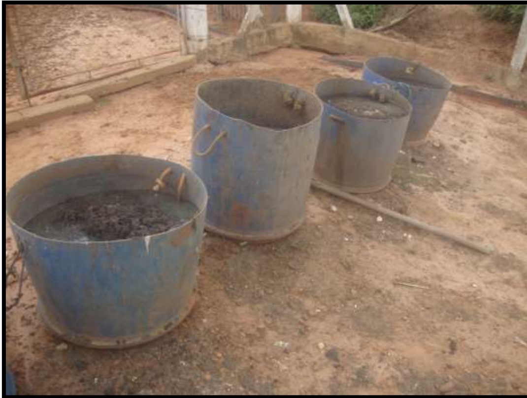
Figura 24 - Resíduos do gradeamento
